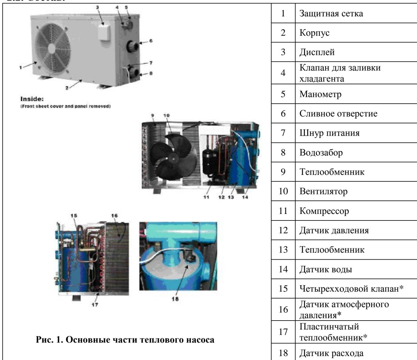
**Рис. 1. Основные части теплового насоса**
