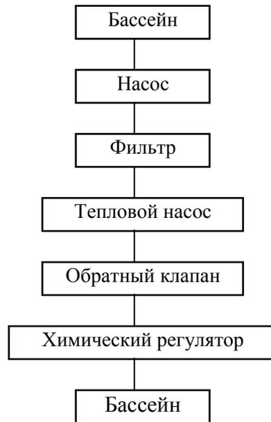
**Рис.4. Гидравлическая схема**
