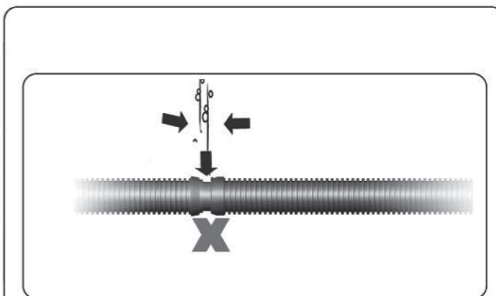
• An den Schlauchverbindungen dürfen keine Undichtheiten auftreten.
